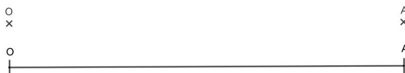
Figure 27 - Illustration de la distance entre deux points (en haut) et de la longueur d'un segment (en bas)
